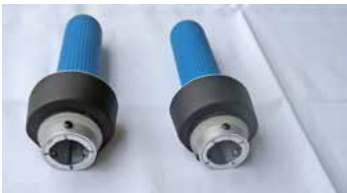
Bei der FlexOmega-Variante Grip sind die Sensoren im Rudergriff eingebaut.
